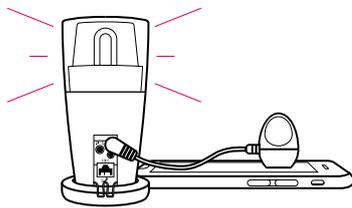
センサが反応すると受信器のLED(黄)が点灯し、フラッシュ光でお知らせします。
