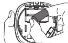
②接続コネクタを引き抜き、電池を取り出す。交換の場合は新しい電池のコネクタを接続し、電池を入れ電池カバーを閉める。
