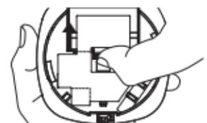
①本器背面のシールのミシン目をツメなどで破り電池カバーを上へ引き上げて開ける。
